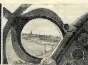
Рис. 2. Видимое положение горизонта из кабины МиГ-15.
